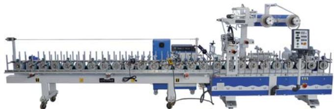
Ламинирующий станок для МДФ-профилей с использованием термоплавкого ПУР-клея-расплава (PUR) и термоплавкого ЭВА-клея посредством щелевого и роликового нанесения. Станина станка состоит из основной части (2,5 м) и сменной зоны окутывания (кассеты) профилей. Имея несколько кассет и настраивая одну из них, можно параллельно работать на второй станине окутывания.
