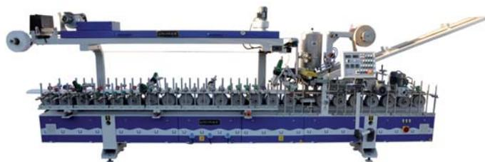
Ламинирующий станок для МДФ-профилей с использованием клеев на основе растворителя, ЭВА и ПО.
