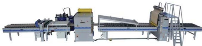
Линия для ламинации панелей укомплектована портативными погрузчиками для автоматической загрузки и приема изделий. Данное дополнение позволяет увеличить объемы производства в 2 раза и работать при скорости до 25 м/мин.
