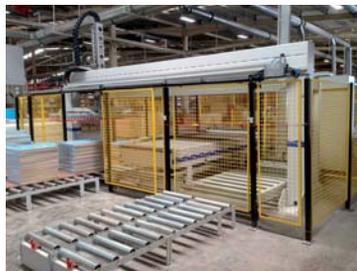
Максимальная ширина панелей до 1300 мм. Оборудование предназначено для ламинации МДФ-панелей декоративными и глянцевыми пленками с использованием ПУР-клея-расплава.
