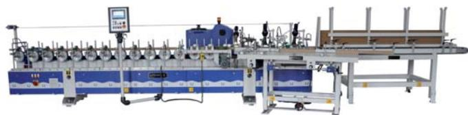
Автоматическая линия для производства наличников с использованием клеев ПУР, ЭВА и полиолефина. Наличники изготавливаются путем приклеивания боковой планки, на которую наносится клей с помощью дюзы. На данной линии можно изготавливать наличники со скоростью 40 м/мин. Также ее можно укомплектовать фрезерным станком для двухстороннего или четырехстороннего снятия углов.
