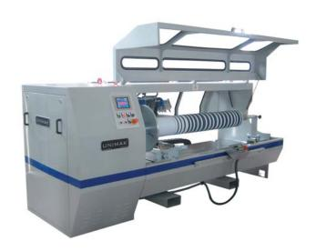
Станок для резки защитной пленки с сервоконтролем в 3-х осях без образования стружки и отходов. Предназначен для резки защитной пленки, маскировочных и двухсторонних клейких лент различной толщины с помощью пилы или дискового ножа. Благодаря точности расчетов специалистов и качественному производству оборудования погрешность нарезки составляет всего 0,1 мм.
