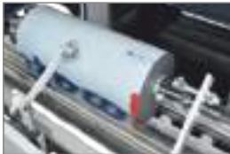
ÜRÜN KESİM GENİŞLİĞİNİN AYARLANMASI İÇİN DAYAMA SİSTEMİ SUPPORT SYSTEM TO ADJUST CUTTING WIDTH OF PRODUCT УПОРНАЯ СИСТЕМА ДЛЯ РЕГУЛИРОВКИ ШИРИНЫ НАРЕЗКИ РУЛОНА
