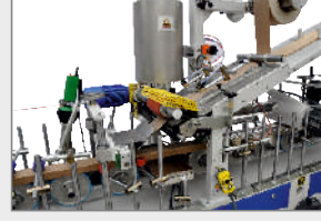
TUTKAL SÜRME MERDANELİ EVA / PO HOTMELT UYGULAMA İSTASYONU EVA / PO HOTMELT APPLICATION STATION WITH ROLLER COATER UZEL ROLIKOVOGO NANESENİYA THERMOPLAVKOGO KLEYA EVA / PO
